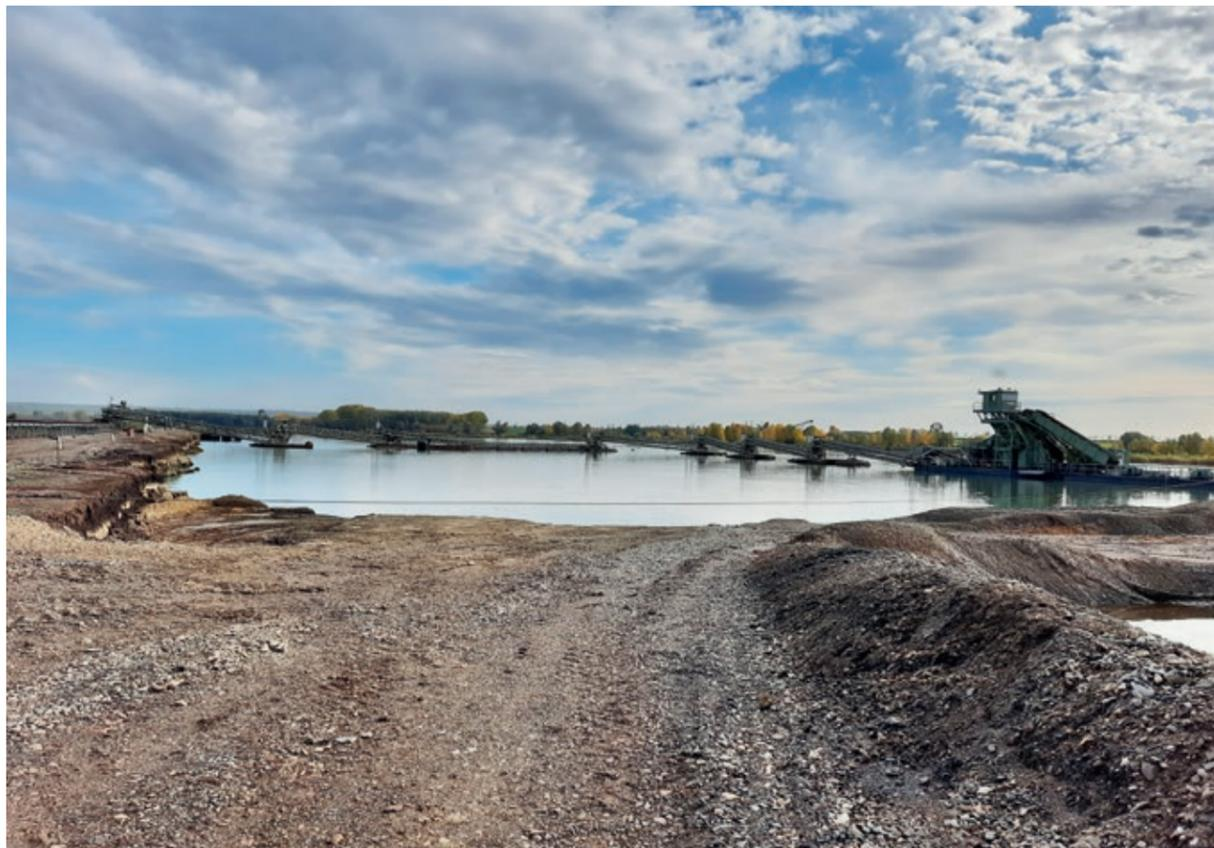
Abb. 3.1-2 Kiesgewinnung bei Dittfurt, im nördlichen Harzvorland. Die Gewinnung befindet sich im Bereich der Bodeaue, der Abbau erfolgt im Nassschnitt (Quelle: LAGB)
