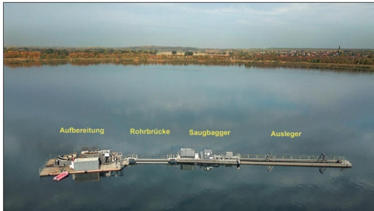
**Abb. 5.3-6** Gesamtansicht der Arbeitsplattform zur Bernsteinengewinnung auf dem Goitzschensee. Der Saugbagger gewinnt in ca. 25 m Tiefe den bernsteinführenden Schluff. Die Schluff-Suspension wird durch Rohre zur Aufbereitung gepumpt, wo die Abtrennung des Bernsteins erfolgt (Foto: S. Schellhorn, 2018)
