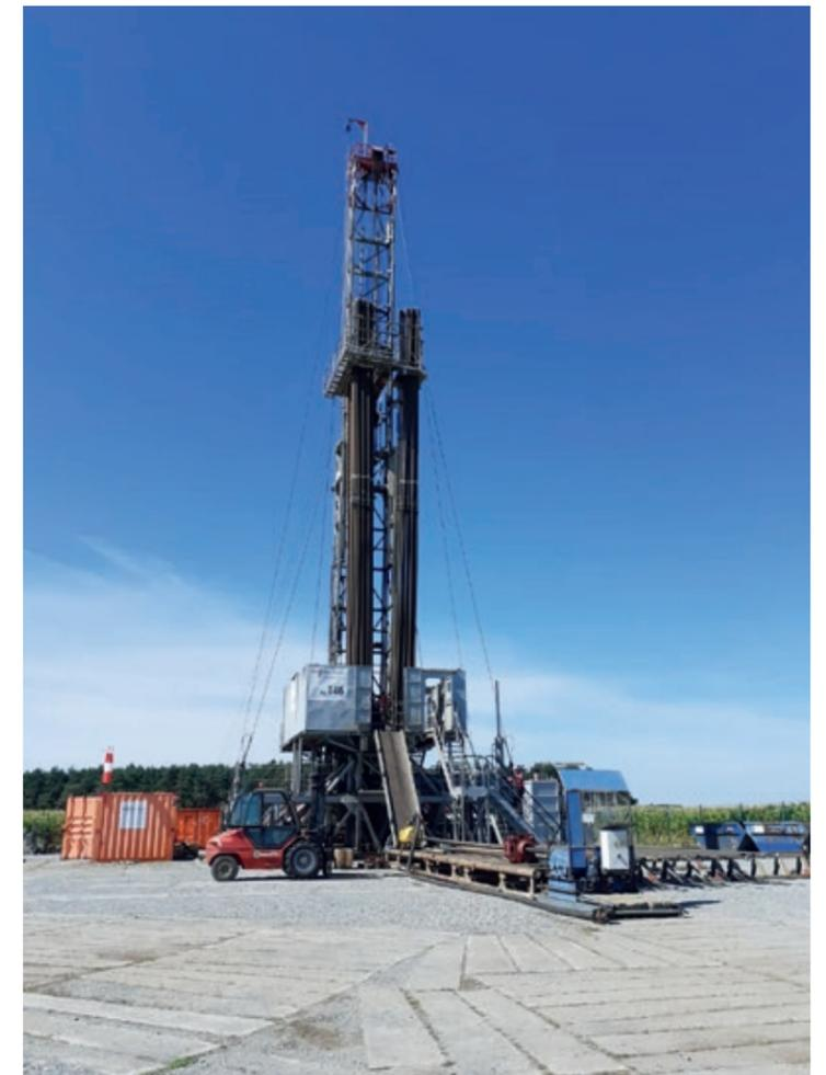
Abb. 2.2-6 Bei Rückbauarbeiten eingesetzte Work-Over-Anlage (Neptune Energy Germany GmbH)
