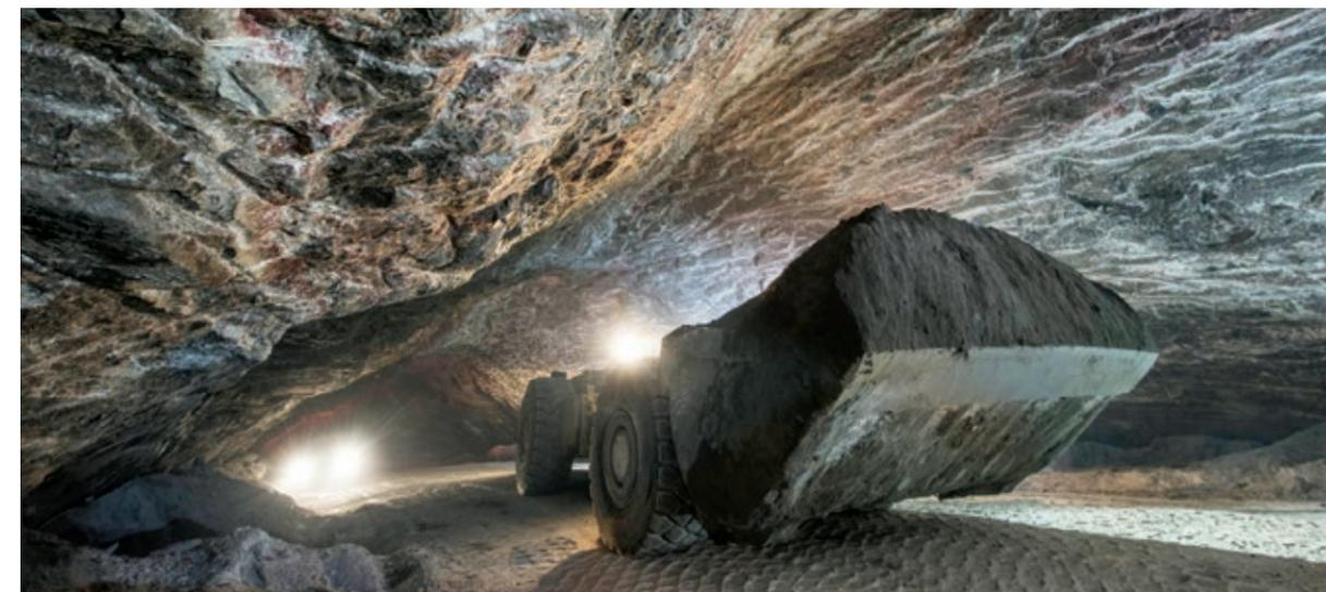
Abb. 2.1-1: Radlader mit Versatzmaterial beim Schüttgutversatz (Quelle: geigergruppe.de)
