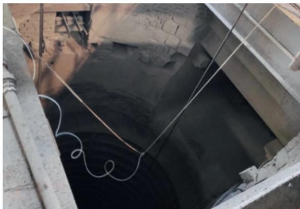
**Abb. 2.1-2:** Emissionsmessungen von Gerüchen am Schacht Neuwerk des Steinsalzbergwerkes Bernburg (Quelle: [unbekannt])
