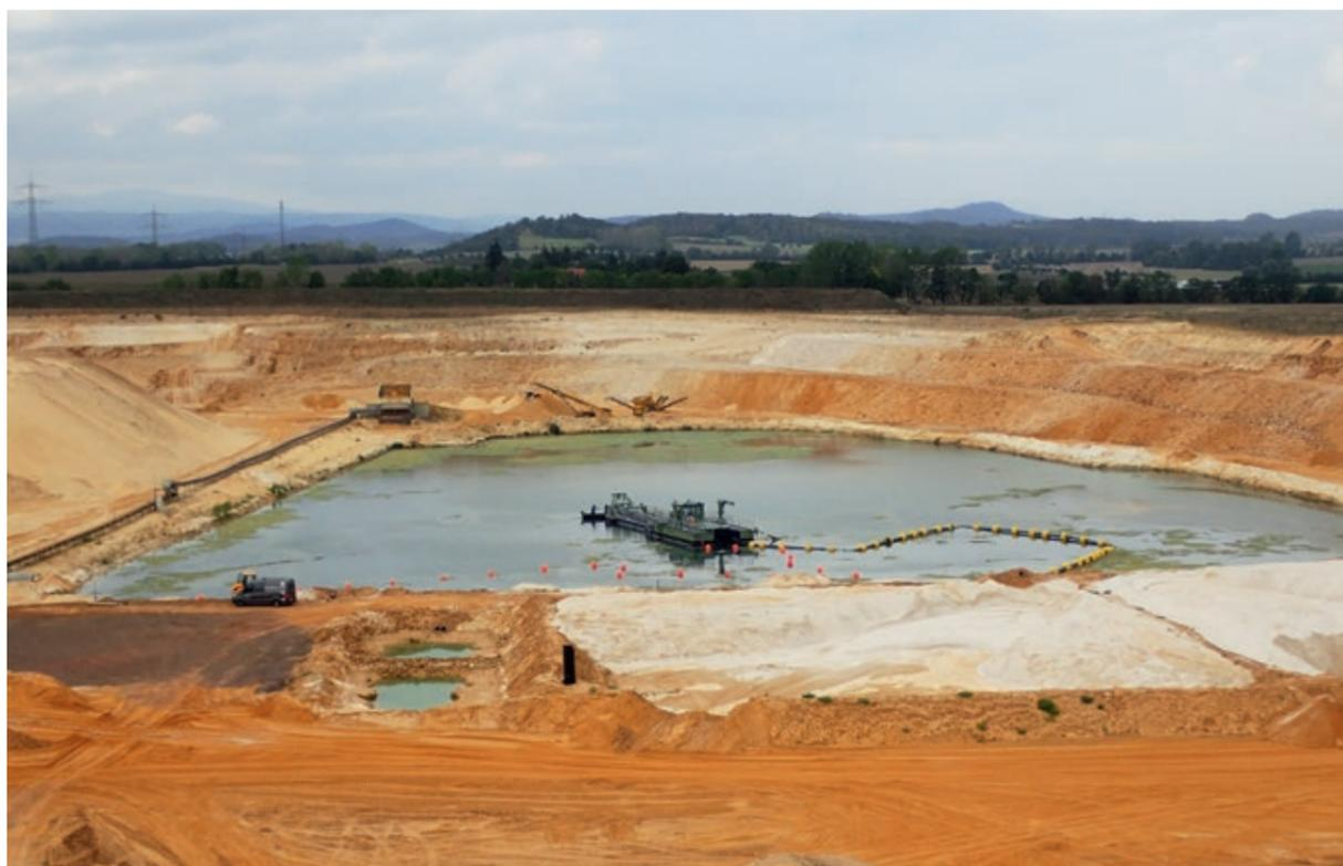
**Abb. 3.1-15** Gewinnung von kreidezeitlichen Quarzsanden am Standort Lehof bei Quedlinburg. Mit Hilfe eines neuen Saugbaggers, der mit einem Schneidrad ausgerüstet ist, können auch stärker verfestigte Sandsteinpartien genutzt werden. Damit kann der Tagebau weiter in die Tiefe geführt werden (Quelle: LAGB).
