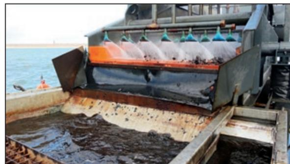
**Abb. 5.3-7** Detail der Aufbereitungsanlage: Wasserstrahlen trennen feines Sedimentmaterial ab, das durch die orangefarbenen Siebe wieder dem Seeboden zugeführt wird. Die Grobbestandteile gelangen in eine Wanne mit Salzwasser (Foto: I. Rappsilber, 2018).
