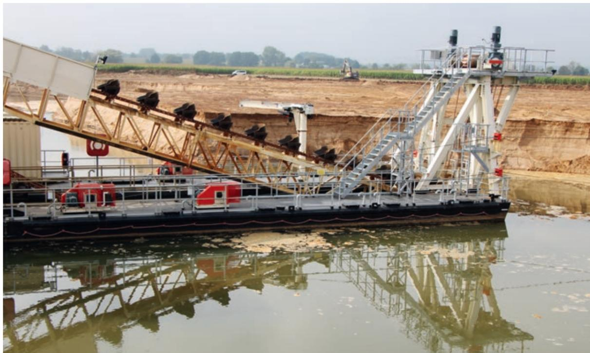
**Abb. 3.3-4** Naßgewinnung von Kiessanden im Bereich der Elbaue. Im Bildhintergrund ist gut erkennbar, dass vor der Gewinnung die Bodensedimente mittels Bagger abgeräumt werden. (Quelle: LAGB)
