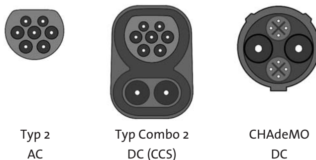
Abbildung 6 – Stecker Typ 2, Typ Combo 2 und CHAdeMO
